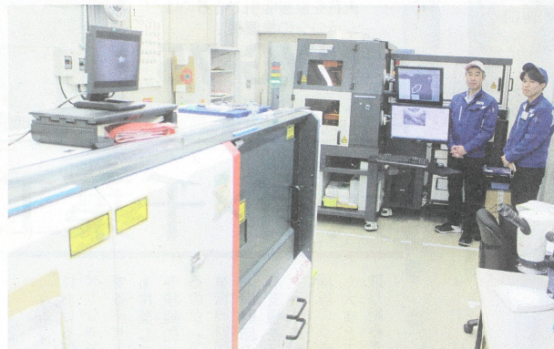
京都工場・R&Dセンターの恒温室に導入したフェムト秒レーザー加工機(奥)とピコ秒レーザー加工機(手前)を紹介する開発部の西川秀樹次長(左)と製造部レーザー加工技術担当の本台優希氏
