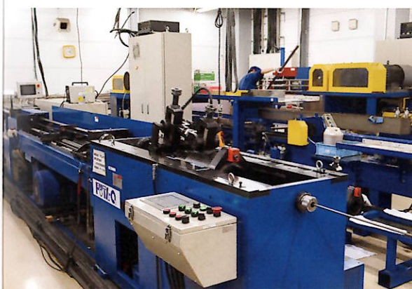
▲「βチタンパイプ」を製造する最初の工程。太い筒状のチタンをこの機械で何度も打ちつけ、伸ばすことで徐々に細くなり、最終的には極細0.3mm(内径)に仕上げる。
