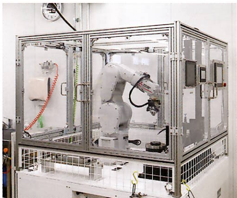
▲メディカル関係の分析機器や工業用ディスクベンサなどに使用されるノズルの先端を作る自社独自開発ロボット。最新の製造設備を備えて、多彩な針先加工への対応や温度制御用のヒーターノズルなどを製作している。
