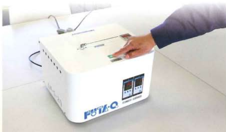
小径パイプ内径壁面粗さ判定装置（自社開発製品）
