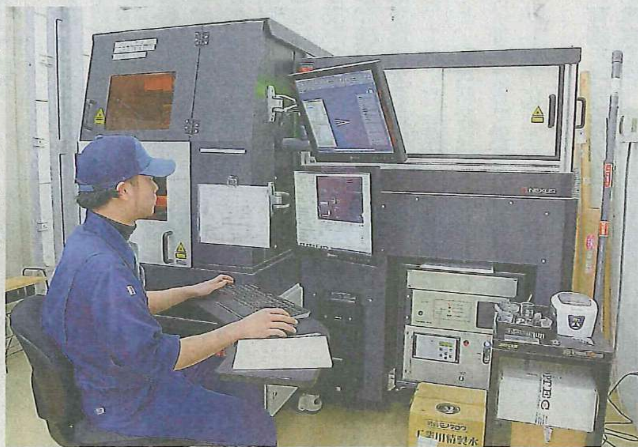
昨年8月に京都工場に導入したフェムト秒レーザー。アクリルや樹脂も加工できる(京都市南区・二九精密機械工業京都工場)
